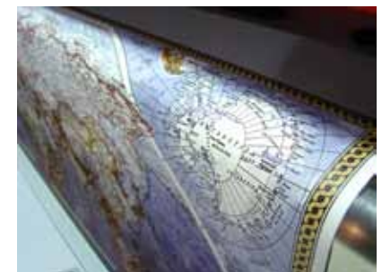
Wysoka, rzeczywista rozdzielczość 1440 x 1400 dpi głowicy DX7 umożliwia dokładny druk, porównywalny z najdroższymi ploterami
