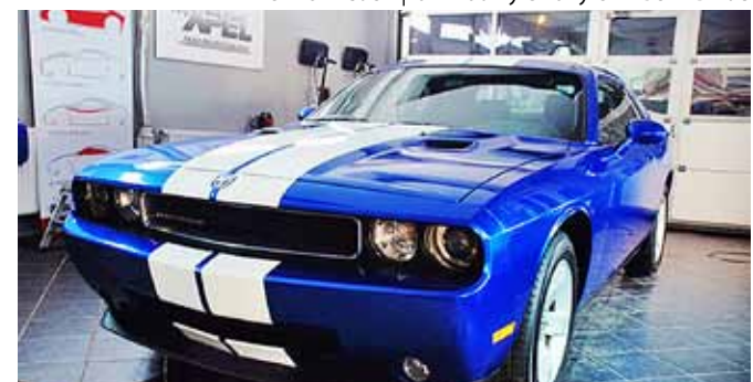
Datexa: Folia ORACAL, seria 970 KOLOR 196 (niebieski metalik), oklejanie zaawansowane z wnękami oraz wewnętrznymi drzwiami
