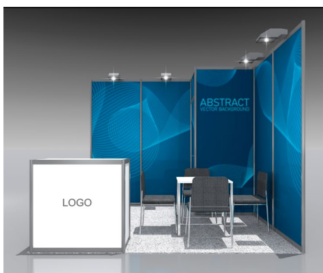
Stoisko narożne, bez fryzu., z grafiką na panelach. W przypadku niektórych stoisk wymagana jest poprzeczką podpierające ścianki na szczycie stoiska.
