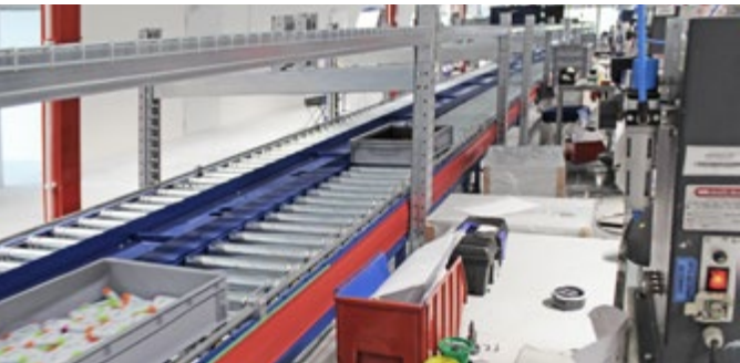
Centrum w Rudzie Śląskiej posiada w pełni zautomatyzowany system przenośników taśmowych o łącznej długości 1,6 km.
