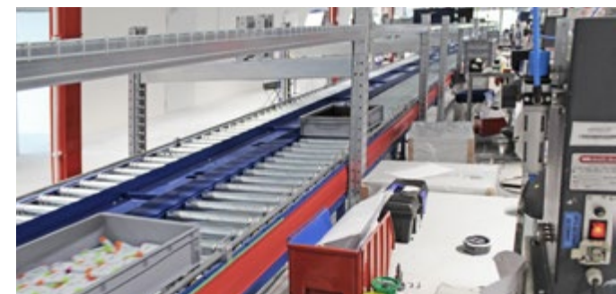
Centrum w Rudzie Śląskiej posiada w pełni zautomatyzowany system przenośników taśmowych o łącznej długości 1,6 km.
