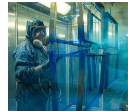
Malowanie proszkowe elementów stalowych.
