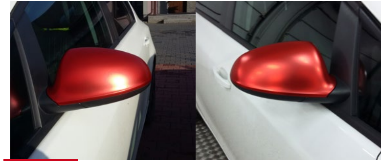
Folia TuningFilm 900 BF to nowa, chromowana, matowa folia do oklejania samochodów firmy MACtac. FlexChrome dostępna jest w 10 kolorach. Ta dwuwarstwowa folia (stabilizowany polimer oraz beżolowowa warstwa chromowa) o grubości 135 mC posiada specjalny klej Micro Bubble-Free, umożliwiający jej bardzo szybką i łatwą aplikację. Źródło: Alma Trend
