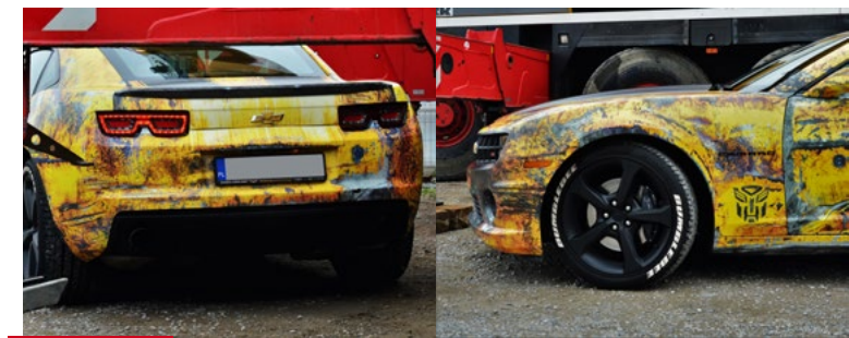
W Stanach Zjednoczonych bardzo modne są tzw. kamuflaże, czyli pełna, często ekstremalna stylizacja samochodu, w dowolnym stylu. Bardzo ciekawy efekt uzyskuje się np. poprzez celowe „postarzenie” auta, przy użyciu specjalnej folii, imitującej rdzę. Przykładem takiej stylizacji w Polsce jest zmieniony przy użyciu folii 3M Chevrolet Camaro, dziennikarza TVN Turbo Patryka Mikiciuka na postać Bumblebee z Transformersów. Praca nad całym projektem trwała kilka miesięcy, a efekt nie byłby możliwy bez zastosowania najwyższej jakości folii 3M. Źródło: Ubieramysamochody.pl
