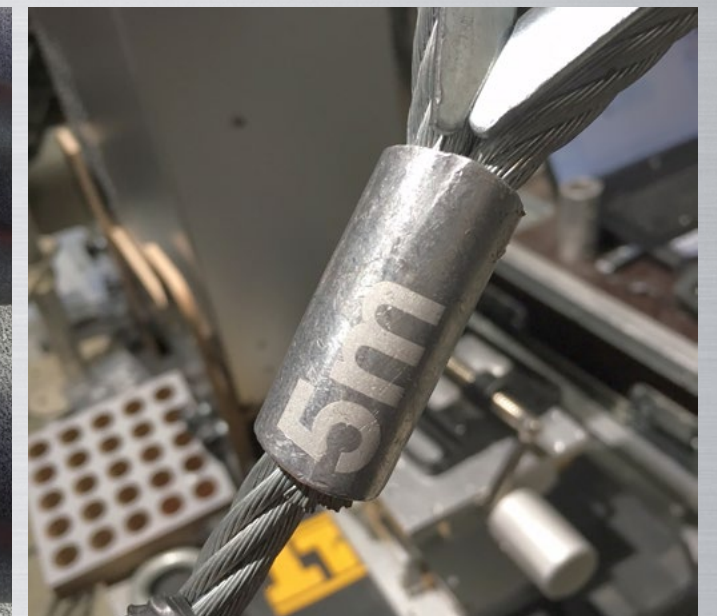
Przykład oznaczenia funkcjonalnego wykonanego na linii stalowej.
